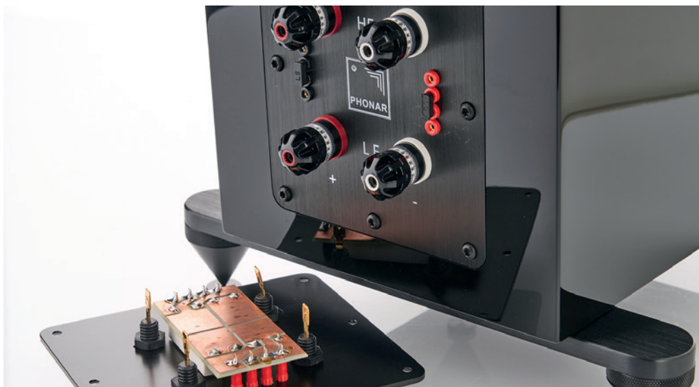
Das hochwertige, mit WBT-Polkklemmen bestückte Anschlussterminal erlaubt Bi-Wiring, Bi-Amping und eine Feinanpassung der Mitteltöner wie auch der Hochtöner-Kalotte
