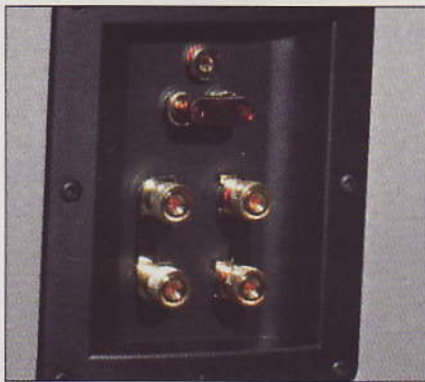
STECKBAR: Der Hochtton wird je nach Stellung des Jumpers etwas abgeschwächt.
